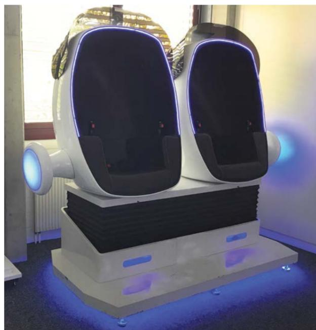
*Reisen nach Fantasia? Im VR-Simulator fühlt sich das wie echt an: Der Sitz bewegt sich synchron zum Filmgeschehen – hydraulische Vibrations- und Windeffekte unterstützen diese Empfindungen.*
